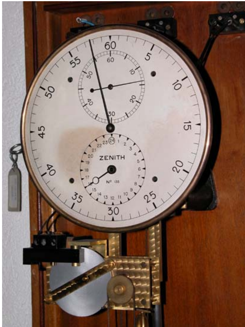
Abb. 11: Präzisionsuhr mit schwerem Sekundenpendel, Zenith. Das Werk wird durch das Gewicht angetrieben. Die Aufzugs-Einheit - basierend auf einem Ferraris Motor - ist getrennt und unter dem Werk platziert. Sie läuft an, sobald das Gewicht nur wenige Millimeter abgelaufen ist. Dadurch wird eine Gangreserve von mehreren Stunden sichergestellt. Das Werk ist konventionell, aber in hervorragender Qualität gefertigt. Es hat eine Grahamhemmung mit Steinpaletten. Die gleiche Uhr gibt es auch in einer Ausführung mit Handaufzug.
