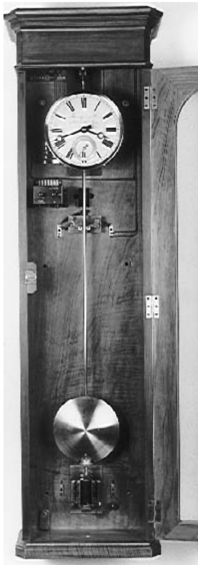
Abb. 2: Hipp's Sekunden-Pendeluhr signiert mit Favarger & Cie, um 1910. Das Zifferblatt ist ein Zähler für die Pendelschwingungen, verbunden mit dem Pendel durch eine Gabel und eine Klinke.
