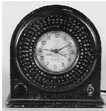
Fig. 29: Amerikanische Synchronuhr für Hotels. Ein Warnsignal kann in 5-Minuten-Intervallen angepasst werden, um den Empfang an das rechtzeitige Wecken der Gäste zu einer bestimmten Zeit zu erinnern.
