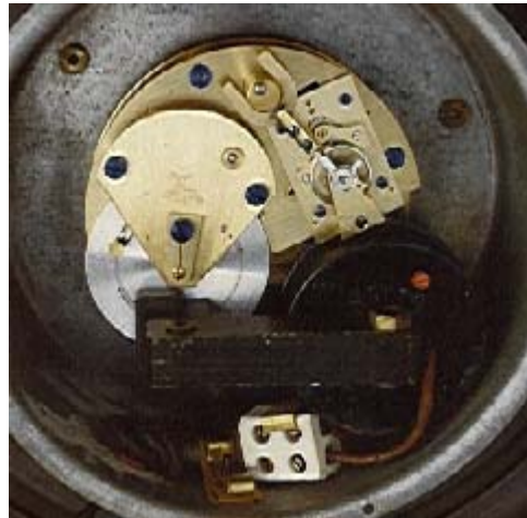
Abb. 10: Wanduhr Ferramo mit Unruh Antrieb, hergestellt durch T. Baeurle & Söhne, Sankt Georgen, Schwarzwald, sie nutzt einen Ferraris Motor für den Aufzug. Der Hauptvorteil dieses Motors ist, dass er leise ist, eine Eigenschaft, die nicht alle elektrischen Uhren für sich beanspruchen können!
