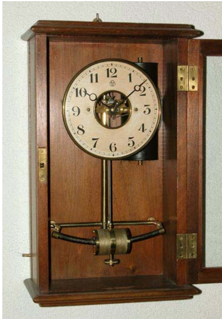
Abb. 4: Bulle-Clock der ersten Periode, um 1920, immer noch signiert mit MFB (für Maurice Favre-Bulle), der diese entwickelte. Sein Markenzeichen stammt von seinem Namen (er war Franzose, aber Favre-Bulle ist ein typischer Name aus dem Schweizer Jura) und hat nichts mit dem Englischen Wort "Bull" zu tun. Die Spule – fixiert am Pendel – und der Permanentmagnet am Gehäuse sind deutlich sichtbar. Der Kontakt (Silbernadel) an der Pendelstange liegt hinter dem Gehwerk. Die Firma bestand bis zum Tode des Gründers im Jahre 1955.
