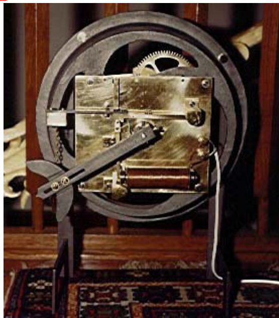
Abb. 21: Turm-Nebenuhr von Campiche, Genf, Ende des 19. Jh. Sie ist unipolar und basiert auf einem typischen französischen Zeigerwerk mit einer zusätzlichen Platte, auf welcher der Elektromagnet und das Gesperr befestigt sind. Ein Gegengewicht dient zum Ausbalancieren des Minutenzeigers.
