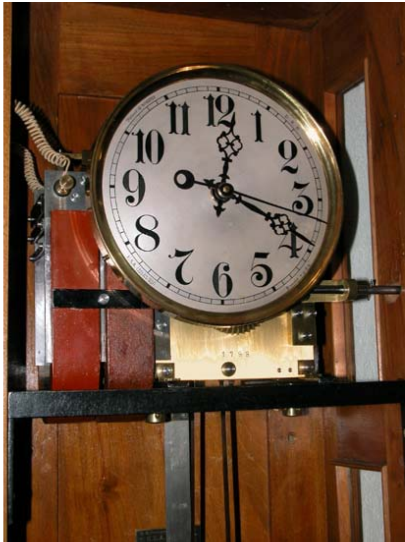
Fig. 24: Magneta Uhr von Martin Fischer aus Zürich, um 1905. Der Induktor (eine Art Dynamo) ist auf der linken Seite des Bildes zu sehen. Das ca. 17 kg schwere Gewicht hängt an einem Stahlband und überträgt seine Kraft durch das Spannen einer starken Speicher-Feder sowohl auf den Induktor (der eine plötzliche und schnelle Bewegung benötigt, um einen Stromimpuls zu erzeugen) als auch auf eine kleine Feder im Federhaus des Gehwerks mit Graham Anker. Das Aufziehen sollte täglich durchgeführt werden und ein im Gehäuse platziertes Alarmsystem schließt einen Kontakt, der eine kleine Lampe aufleuchten lässt, sobald das Gewicht wieder hochgezogen werden muss. Wird die Uhr nicht aufgezogen, so wird das Pendel vorsorglich angehalten, da sonst die angeschlossenen Nebenuhren lange vor der Hauptuhr nicht mehr funktionieren würden. Dieser Zustand kann eintreten, wenn das Gewicht auf dem Gehäuseboden aufsteht. In diesem Fall hält die Elastizität des Stahlbandes das Hauptuhrwerk noch für einige Zeit in Gang, aber die Energie reicht nicht aus, um den Induktor zu bewegen. Später, während der Zeit von Landis & Gyr, wurden diese Uhren alle mit einem elektrischen Aufzug versehen.
