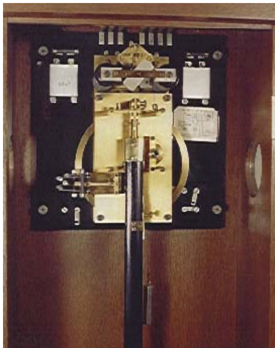
Abb. 8: Eine EZ (Elektro-Zeit, später T&N = Telefonbau & Normalzeit) Uhr aus den 30er Jahren des 20. Jh. Im Gegensatz zum herkömmlichen Klinken- und Sperrad-Aufzugssystem, das in vielen elektrisch aufgezogenen
